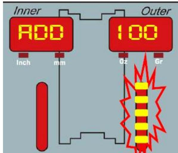
Вы должны прикреплять грузик в данном положении, иначе расчётный угол будет неправильным, для оказания влияния на точность измерений. Снова запустите станок и
