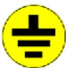
**Символ заземления:** Данный ярлык, расположенный с левого края станка указывает на место подсоединения провода заземления.
