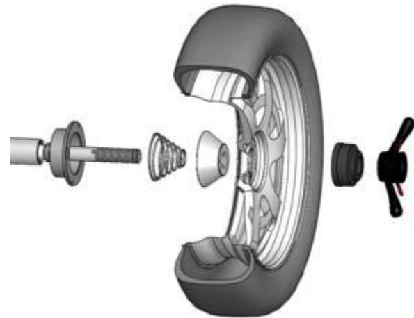
Главный вал → коническая пружина → конус → колесо → прижимная чашка → быстросъемная гайка.
