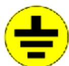
**Символ заземления:** Данный ярлык, расположенный с левого края станка указывает на место подсоединения провода заземления.
