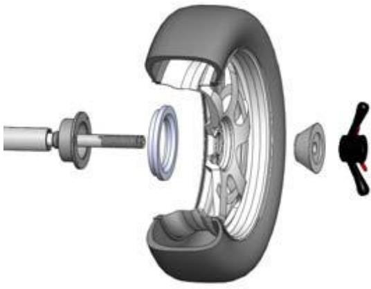
Главный вал → фланцевый адаптер (зафиксированный на главном валу) → колесо → конус → быстро съемная гайка.
