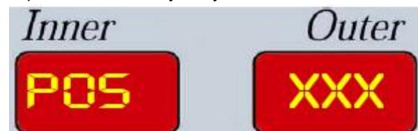
В положении **STA** нажмите на пьезоэлектрический датчик вертикально относительно ведущего вала. Величина в правом окне изменится. Это означает, что установка датчика верна.
