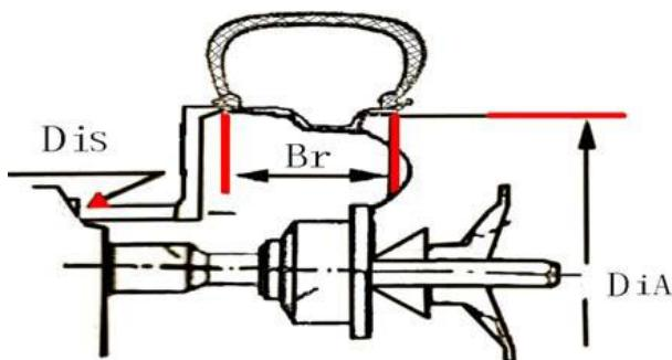
3.1 Вытяните линейку балансировочного станка для измерения величины Di, которая означает расстояние от внутренней стороны шины до корпуса. Согласно результатам измерений, единицей измерения является см,
