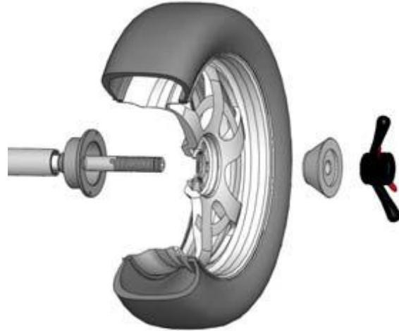
Главный вал → колесо (направление установки поверхности обода - внутри) → конус → быстросъёмная гайка.
